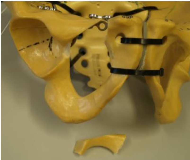
Abb. 31 : Ausbrechen eines Fragments im Bereich des vorderen Pfeilers bei einer Belastung von ca. 630N
