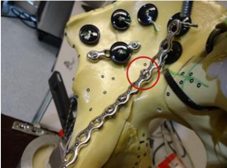
Abb. 28: Ausbruch der dorsalen Osteosyntheseschraube mit der LP-Platte bei ca. 330N im Rahmen der Vorversuche.[9]
