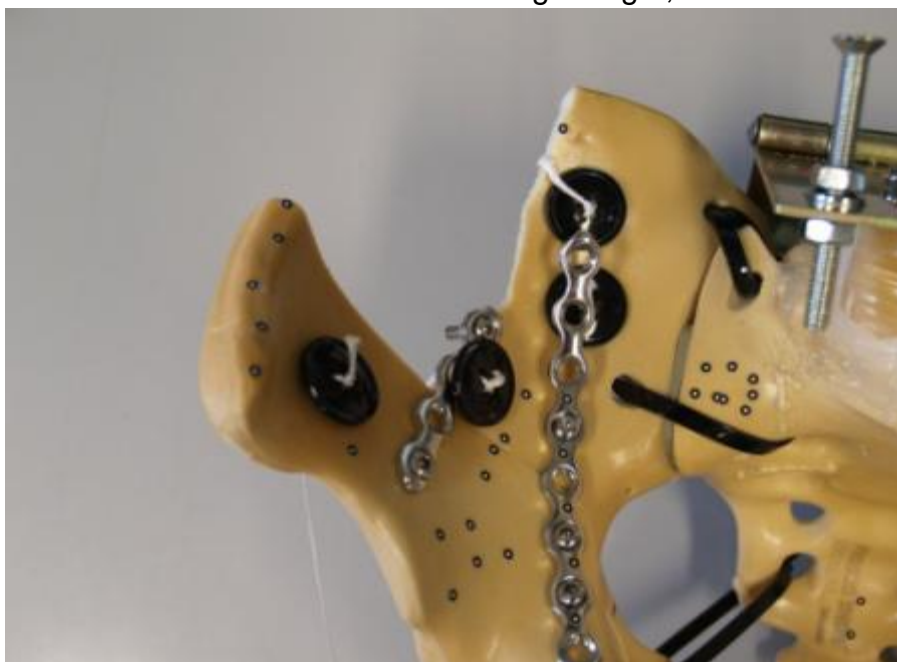
Abb. 45: Bruch des äußeren, dorsalen Beckenkamms bei ca. 400N Belastung
