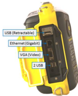
Ilustración 23: Conectores lateral izquierdo del equipo. [11]
