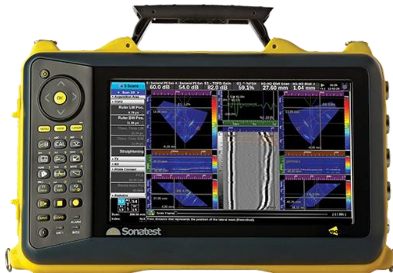
Ilustración 6: Equipo de inspección por ultrasonido [5]
