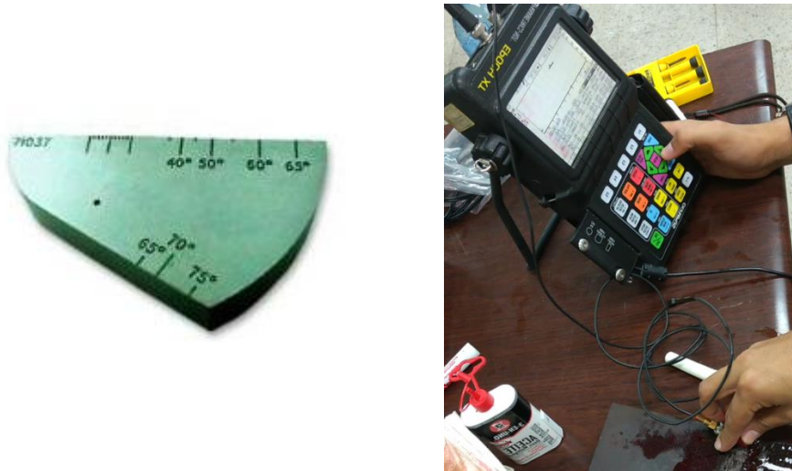
Ilustración 24: Equipo UT convencional utilizado para la comparación. Fuente propia.
