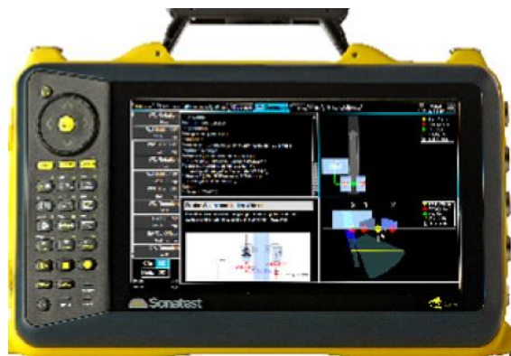
Ilustración 20: Equipo VEO 16:64 SONATEST. [11].
