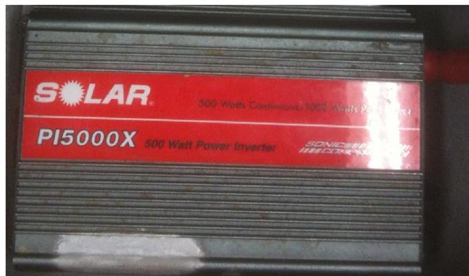
**FIG 11. Inversor de 500 watt utilizado**
