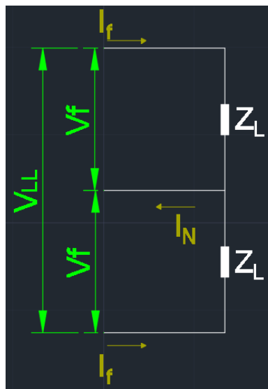
Figura 11. Sistema monofásico trifilar balanceado
