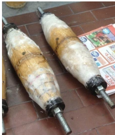
Figura 19. Prototipo del elemento de Guadua con fibra de vidrio
