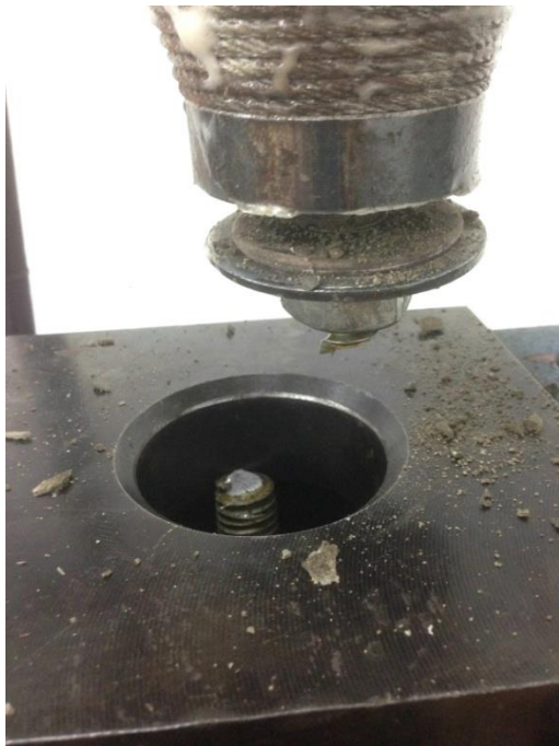
Figura 28. Tornillo zincado de 3/4'' después de ensayo
