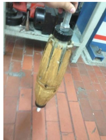
Figuras 16. Prototipo del elemento de Guadua original después de prueba a tracción
