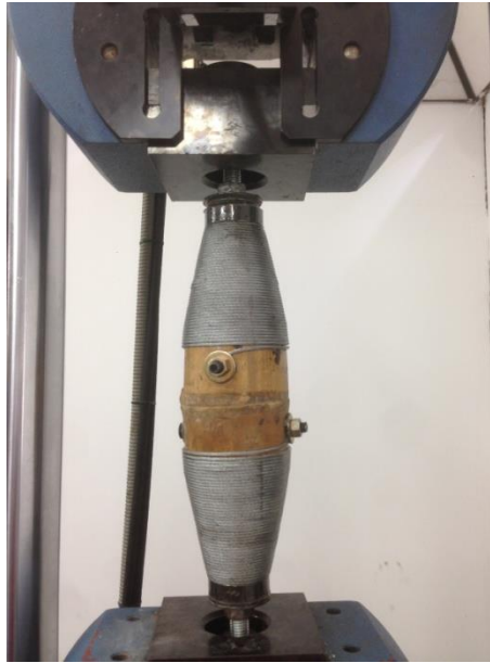
Figura 21. Prototipo del elemento de Guadua con guaya metálica de 1/8"
