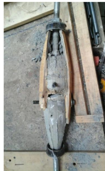
Figura 23. Prototipo del elemento de Guadua con guaya metálica de 1/8" desarmado
