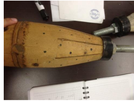
Figura 18. Prototipo del elemento de Guadua con clavos de acero
