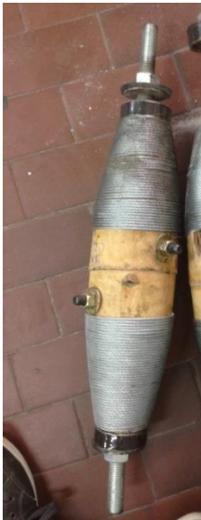
Figura 22. Prototipo del elemento de Guadua con guaya metálica de 1/8" ensayada a tracción
