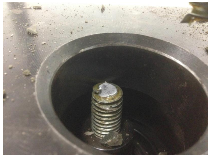
Figura 29. Tornillo zincado de 3/4'' después de ensayo
