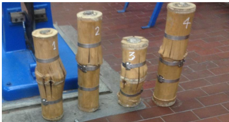
Figura 14. Guaduas cepas con cinta Band-it ensayadas a compresión
