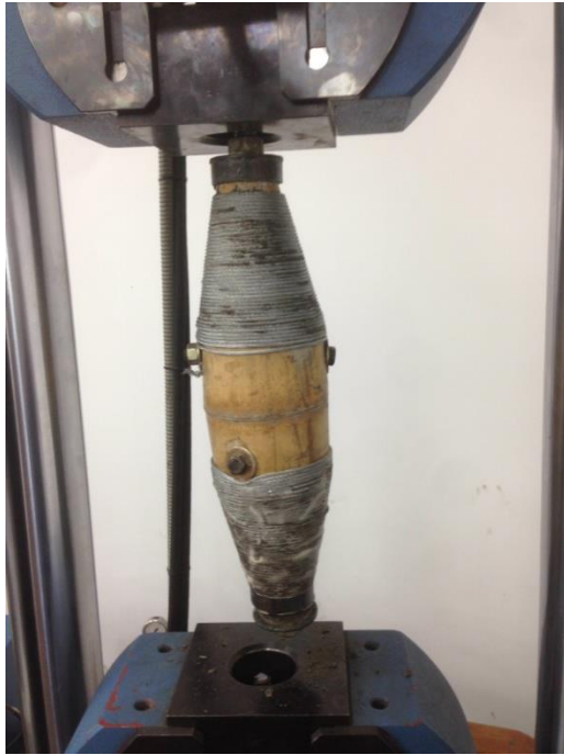
Figura 26. Prototipo elemento de Guadua final ensayado
