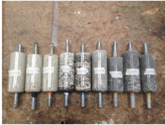
Figura 4. Probetas de tracción hechas con materiales minerales
