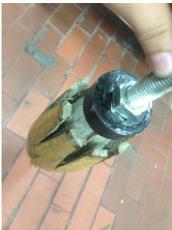
Figuras 15. Prototipo del elemento de Guadua original después de prueba a tracción
