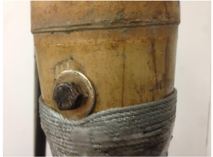
Figura 27. Perno transversal después de ser ensayado
