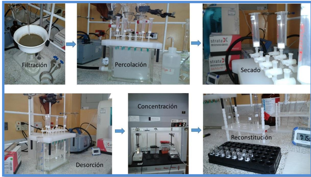
Figura 8. Esquema de extracción en fase sólida. Fuente el autor.
