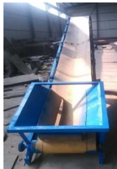
Figura 15. Banda transportadora que conecta el triturador de neumáticos con la trituradora de caucho
