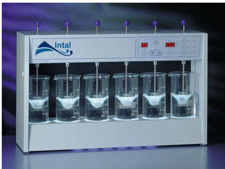
Figura 13. Montaje para la prueba de jarras.
