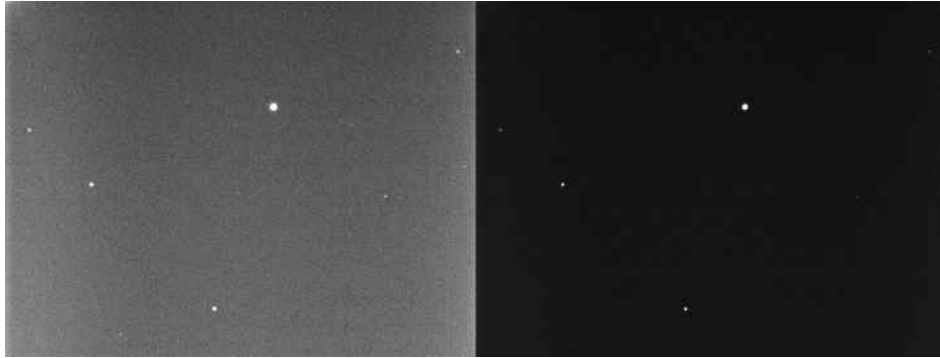
Figura 5.22: Comparación de la imagen de luz de la estrella HD 25752 antes y después de la sustracción del Master Dark. Fotografías adquiridas por las autoras en el OAUTP el 20 de Agosto de 2016 4:55 a.m. Tiempo de exposición: 4 segundos. Filtro: V.
