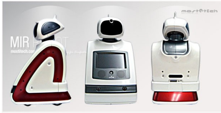
Figura 2.9: Robot de seguridad MIR [16]
