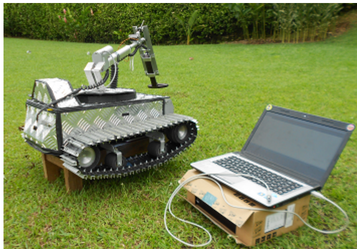
Figura 2.10: Prototipo robótico detector de minas antipersonas [17]
