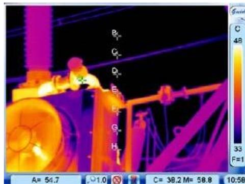
Para mover cada punto después de seleccionarlo, hacer clic con la pluma del toque, arrastrar a la posición deseada y entonces liberarlo; mover el joystick de arriba o abajo y de la izquierda a derecha hasta la posición que se desee y entonces liberarlo. La temperatura del punto mostrada en la barra de estado cambiará de acuerdo con los movimientos del punto.
