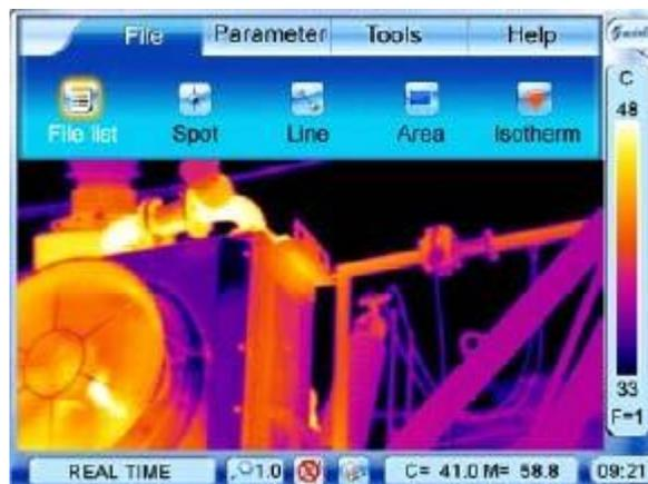
**Figura 41. Imagen termográfica en tiempo real, que muestra el submenú parámetros y sus opciones.**
