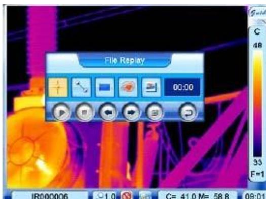
**Figura 34. Barra de herramientas para la reproducción de imágenes termográficas guardadas.**
