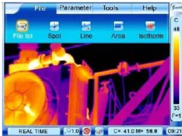
En las imágenes congeladas, desplegar la barra de herramientas congelada con la pluma de toque o el joystick. Hacer clic en el ícono de análisis de puntos con la pluma de toque para seleccionarlo, o mover el joystick para resaltar el ícono de análisis de puntos primero y luego presionar el joystick para seleccionarlo ver la Figura 45.
