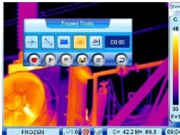
En las imágenes guardadas, el análisis isotérmico puede realizarse cuando las imágenes son reproducidas. Desplegar la barra de herramientas de repetición con la pluma de toque o con el joystick. Hacer clic en el ícono de análisis Isotérmico con la pluma de toque para seleccionarlo, o mover el joystick para resaltar el ícono de análisis Isotérmico primero y luego presionar el joystick para seleccionarlo ver la Figura 58.
