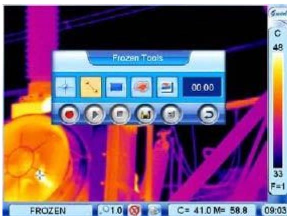
En las imágenes guardadas, el análisis de la línea puede realizarse cuando las imágenes son reproducidas. Desplegar la barra de herramientas de reproducción con la pluma del toque o con el joystick. Hacer clic en el ícono de análisis de Línea con la pluma de toque para seleccionarlo o mover el joystick para resaltar el ícono de análisis de Línea, primero y luego presionar el joystick para seleccionarlo ver la Figura 50.
