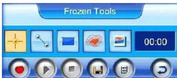
**Figura 27. Funciones de los íconos de la barra de herramientas para congelamiento de imágenes termográficas**
