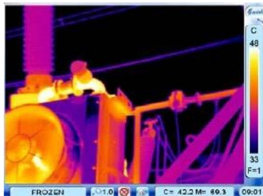
Al presionar el botón S otra vez, se puede guardar directamente la imagen congelada en la memoria (interna o tarjeta de memoria). Entonces el nombre de la imagen guardada "IR \* \* \* \* \*" se desplegará en la barra de estado bajo la pantalla de la imagen durante 2 segundos ver la Figura 24.
