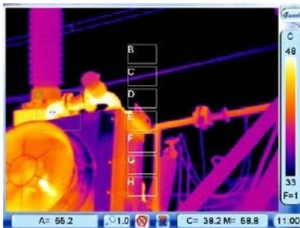
Para mover cada área después de seleccionarla, hacer clic en el centro con la pluma de toque, moverla a una posición adecuada y entonces soltarla, o mover el joystick de arriba a abajo y de izquierda a derecha hasta una posición adecuada y entonces liberarla. La temperatura desplegada en la barra de estado cambiará de acuerdo con esto.
