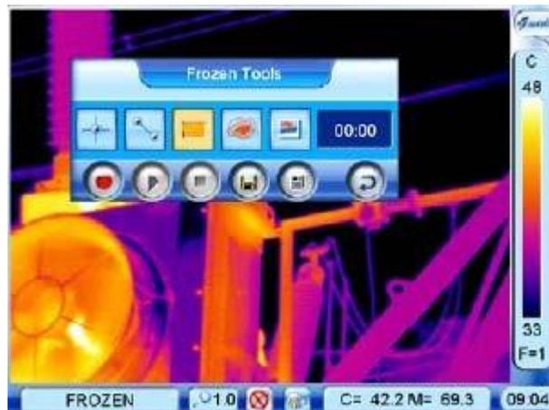
En las imágenes guardadas, el análisis del área puede realizarse cuando las imágenes son reproducidas. Desplegar la barra de herramientas de reproducción con la pluma de toque o con el joystick. Hacer clic en el ícono de análisis del área, con la pluma de toque para seleccionarlo o mover el joystick para resaltar el ícono de análisis del área primero y luego presionar el joystick para seleccionarlo ver la Figura 54.
