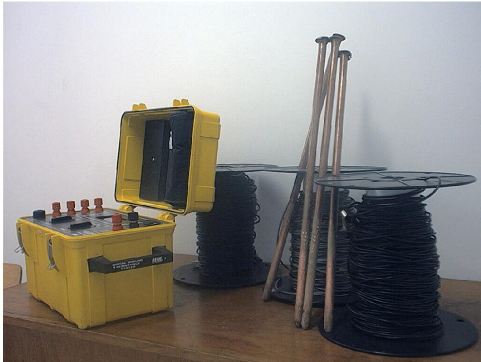
Imagen 53: Detalla del equipo AEMC 4500 y accesorios
