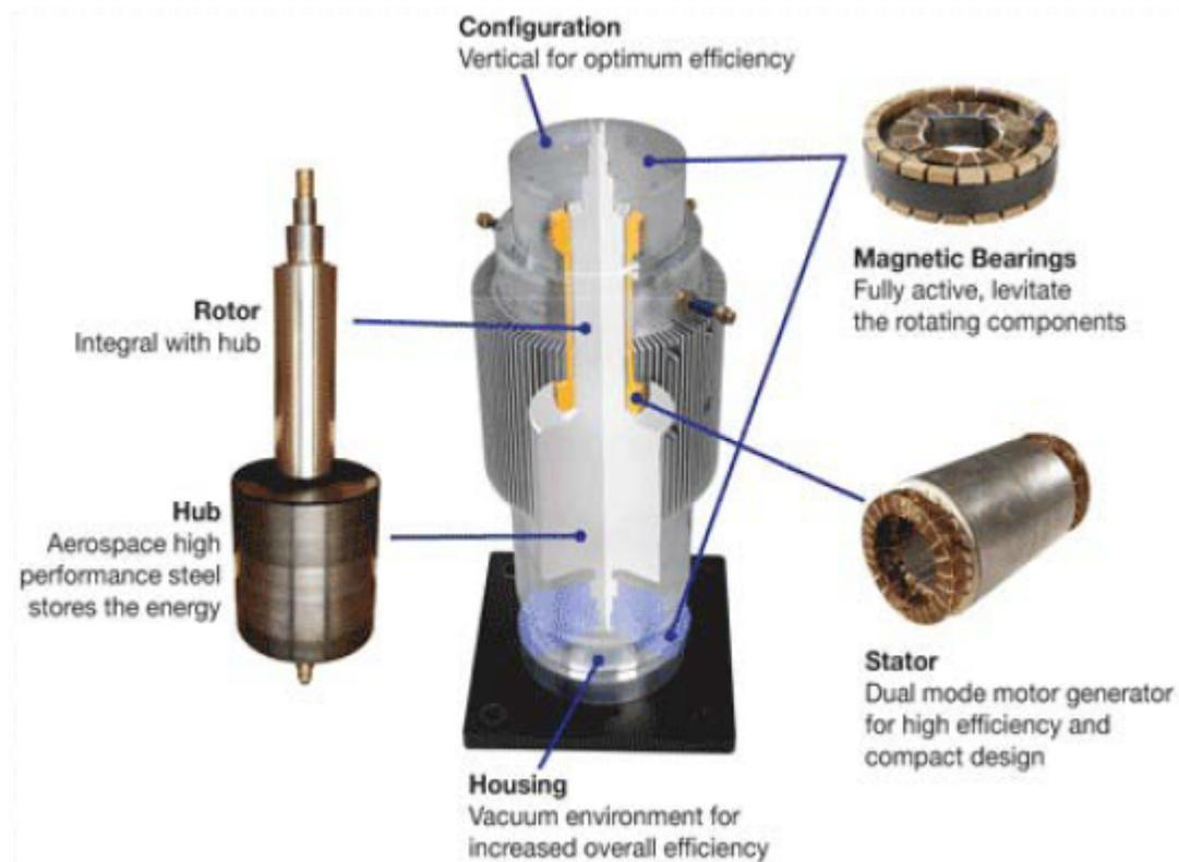
Figura 2.2: Volante de inercia y sus componentes [6].
