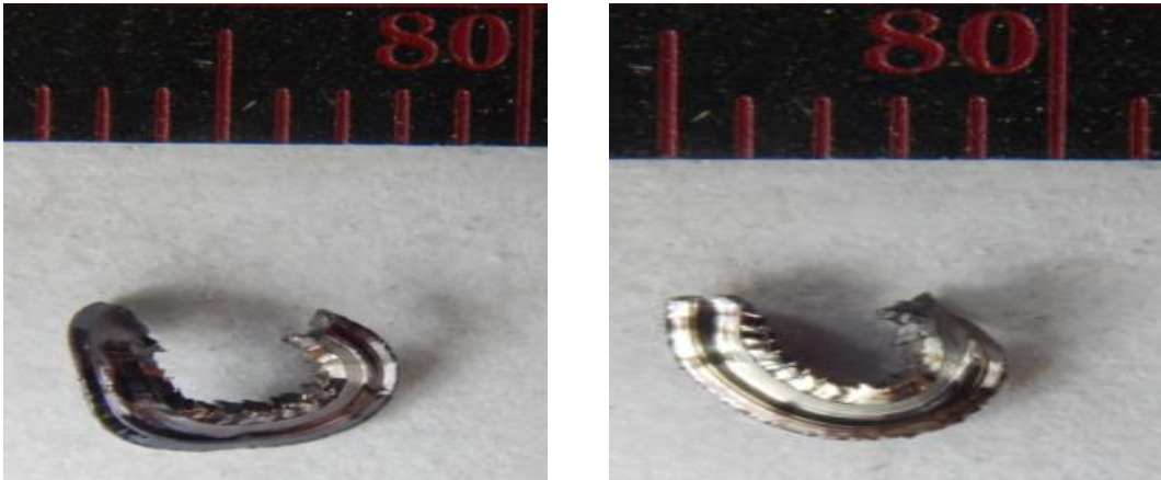
Figura 28. HM EPT viruta obtenida de la experimentación con pulsos [24]
