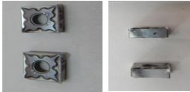
Figura 6. Inserto HM utilizado en los ensayos [24]
