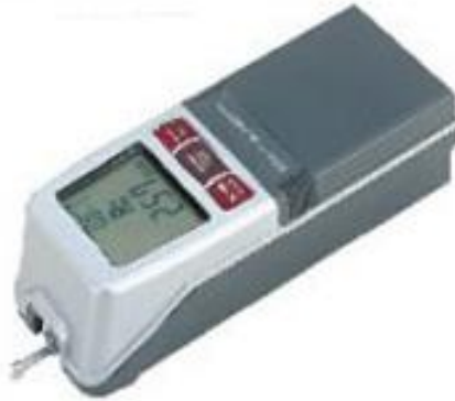
Figura 13. Rugosímetro JS201 P utilizado [24]
