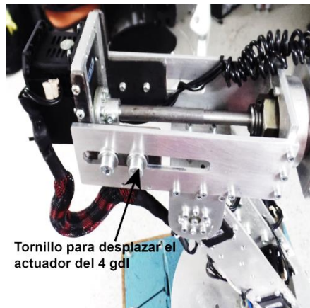
Figura 26. Sistema para el desplazamiento del cuarto gdl
