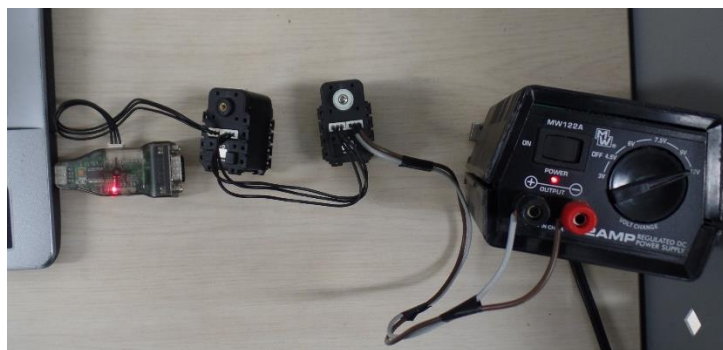
Figura 32. Conexión del dispositivo USB2Dynamixel con los actuadores
