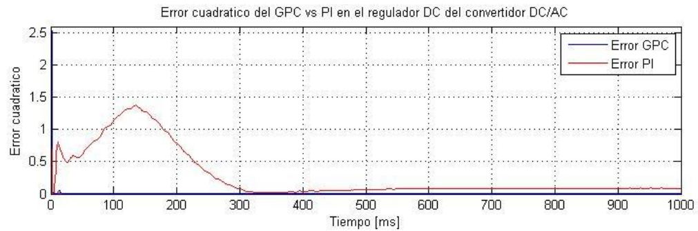
Figura 4.3. Error cuadrático del GPC vs PI en el regulador DC del convertidor DC/AC.
