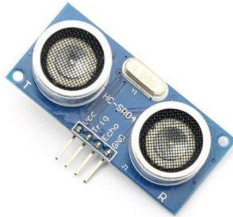
Figura 6. Sensor de ultrasonido HC - SR04
