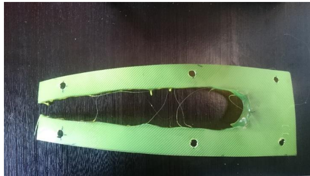
Figura 24. Probeta polipropileno 0,5 [mm]: a) antes del ensayo, b) durante el ensayo, c) después del ensayo. (Autor)
