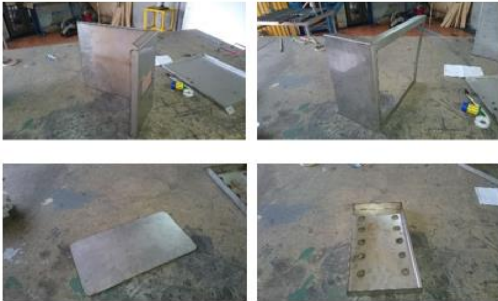
Figura 11. Elementos mecanizados de la cámara de combustión. (Autor).
