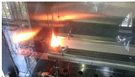
Figura 22. Inicio de llama en la probeta. (Autor)
