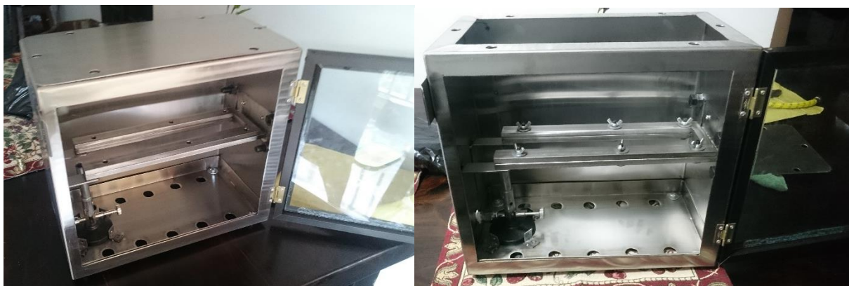
Figura 18. Cámara de combustión, mechero y porta probeta. (Autor)
