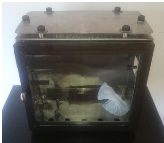
Figura 17. Tapa superior y puerta unidas a la cámara (autor)
