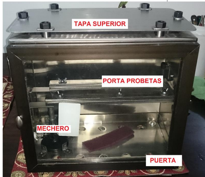
Figura 19. Cámara para ensayos bajo la norma FMVSS 302. (Autor)
