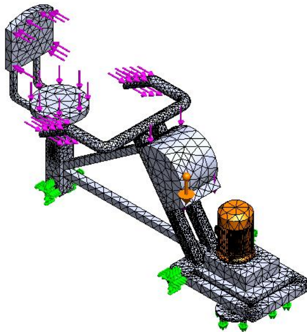
Figura 31. Mallado sólido y cargas aplicadas al equipo
