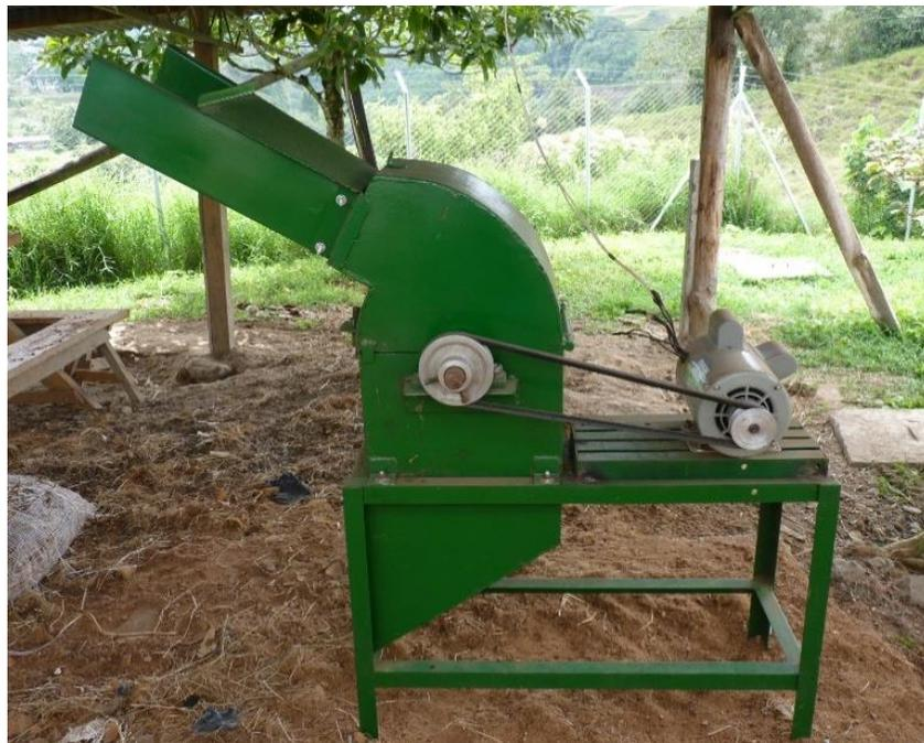
*Figura 2 – Trituradora de martillos a automatizar*
