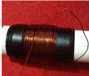
*Figura 9 Bobinado de cobre*
