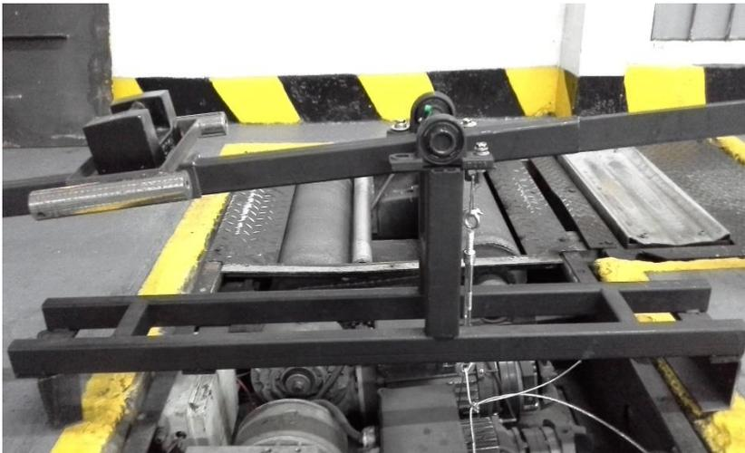
Figura 11. Palanca de calibración de Especialistas en Metrología S.A.S.
