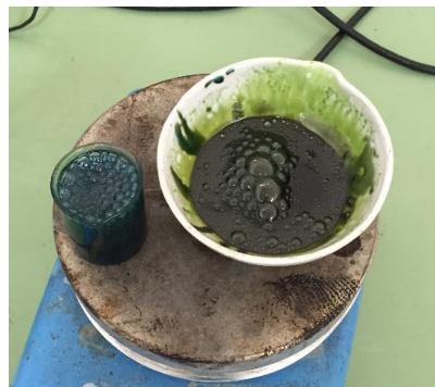
Fig. 39 Gelificación a 105 min con T > 80^{\circ}\text{C} [Autor]
