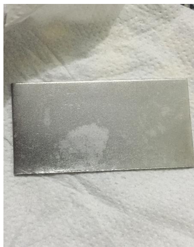
Fig. 25 Sustrato al final de prueba del Método de limpieza con bicarbonato y limón [Autor]
