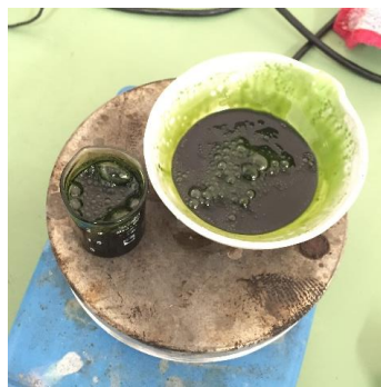
Fig. 38 Gelificación a 30 min con T > 80^{\circ}\text{C} [Autor]
