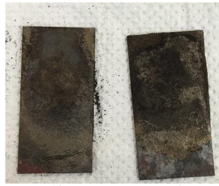
Fig. 46 Sustratos con recubrimiento absorbente selectivo. Izquierda un ciclo inmersión-tratamiento. Derecha dos ciclos inmersión-tratamiento [Autor]
