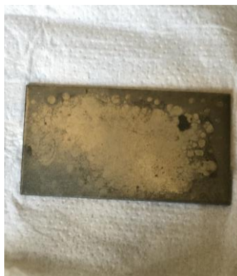
Fig. 23 Resultado del Método de limpieza con Coca-Cola [Autor]
