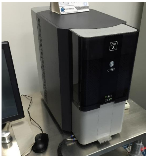
Fig. 48 SEM utilizado para caracterización, perteneciente a Tecnoacademia SENA Dosquebradas [Autor]
