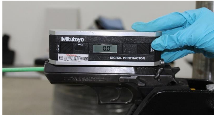
Fig. 22. Verificación de la inclinación del arma.
