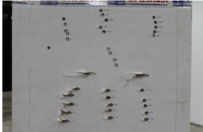
Fig. 7. Orificios de entrada para cada ángulo de incidencia en lámina de Drywall Fuente: propia.
