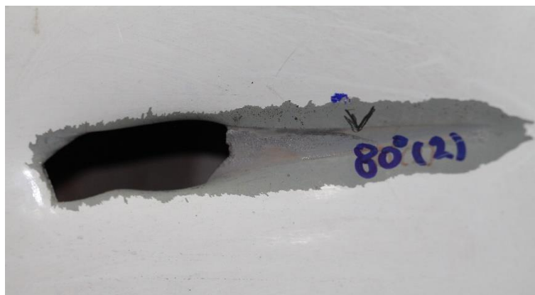
Fig. 29. Morfología del O.E para un ángulo de incidencia de 10° y de disparo de 80°.
