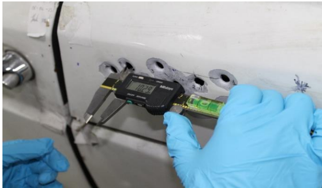
Fig. 17: Manejo del calibrador para la toma de medidas.
