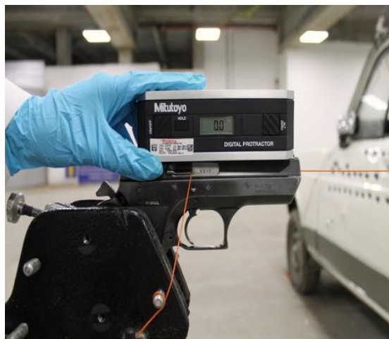
Fig. 25. Inclinación del arma antes del disparo. Fuente: propia.
