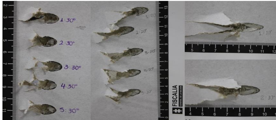
Fig. 11. Orificio de entrada para ángulos de incidencia de 30°, 20° y 10°.
