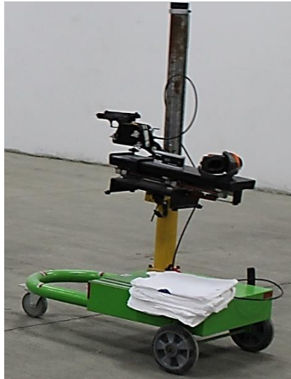
Fig. 14: Soporte para fijar y disparar armas de forma segura.
