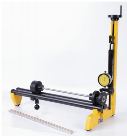
Figura 23. DT8: 00 Aparato de torsión de barras.
