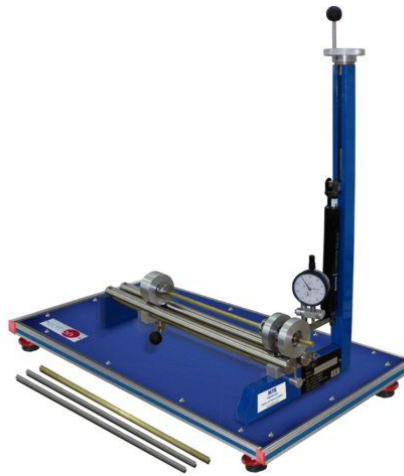
Figura 5. Equipo de torsión en barras MTB.
