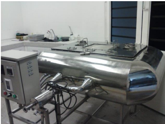
Figura 61. Bio-reactor para la producción de biosustancias por fermentación en estado sólido, empleando hongos macromicetos.
