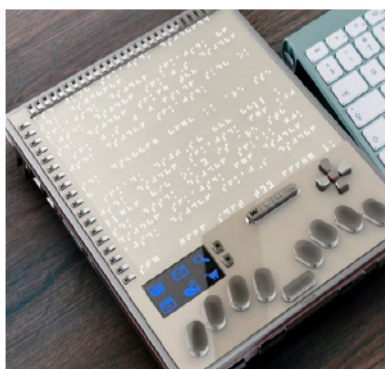
Figura 26. BLITAB, tablet tátil (imagem retirada de www.blitab.com ).
