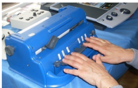
Figura 17. Escrita em Braille pela Máquina Manual de Escrever Braille.
