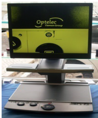
Figura 30. Ampliador de Mesa incorporado no Computador.
