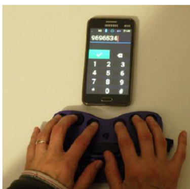
Figura 23. Linha de Braille para telemóvel smartphone .
