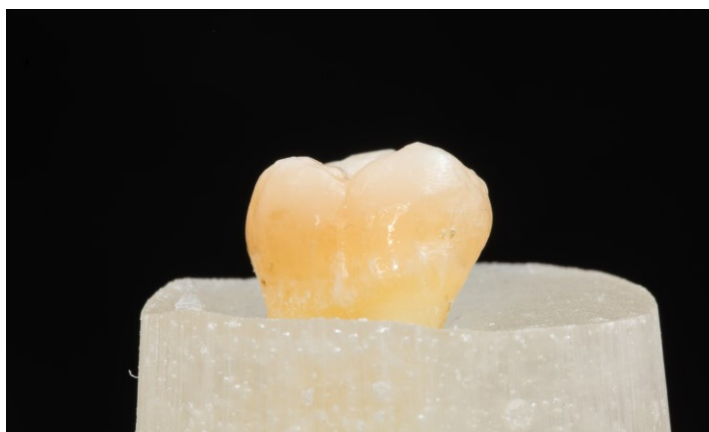
Figura 6. Amostra incluída em resina acrílica de polimetacrilato.
