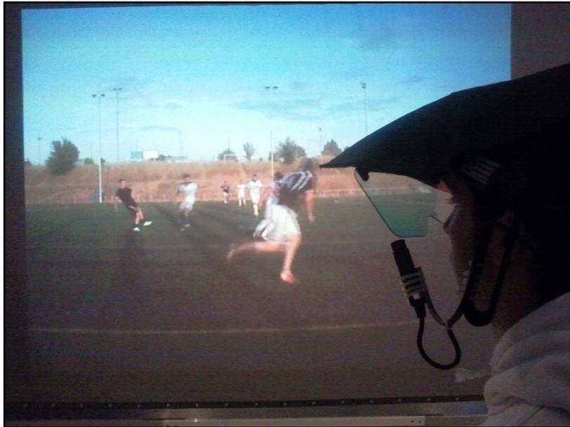
**Figura 1.** Ejemplo de visualización de la acción de fuera de juego en fútbol en situación de laboratorio, con el ASL Eye Tracking SE5000 incorporado.
