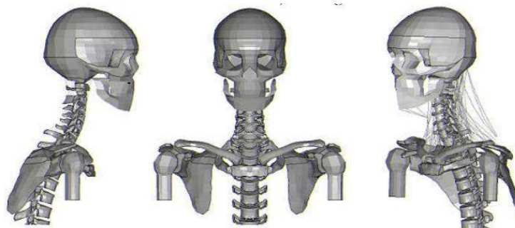
Figura 44: Modelo numérico craniocervical KTH, com músculos compostos por elementos descontínuos, Hill type, de Halldin e Brolin. Hedenstierna S. (2008) [5].
