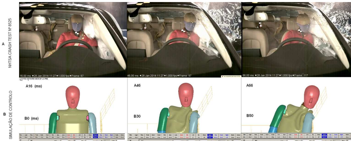
Figura 65: Análise comparativa cinemática entre o NHTSA Crash Test nº8525 e o impacto de controlo com módulo de elasticidade cervical a 100%, nas fases 0 ms; 30 ms; 50 ms.
