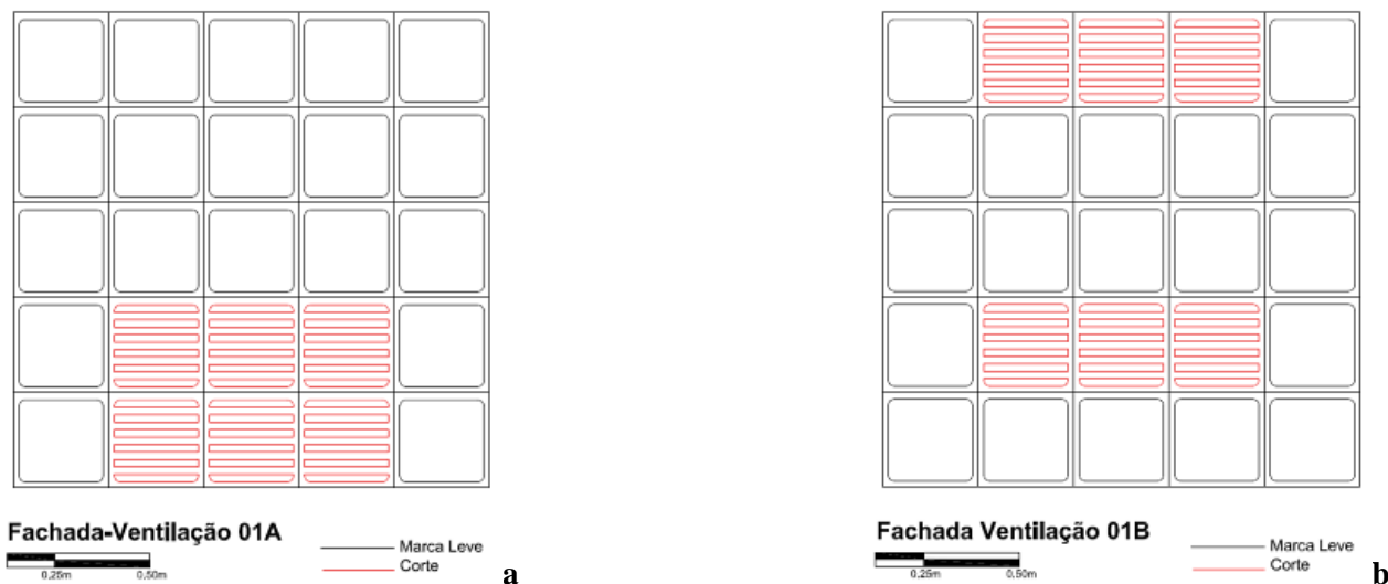
Figura 6a-b. Detalhe do tipo de grelha do módulo de ventilação para os casos 01A e 01B.
