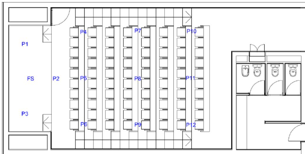
Figura 4. Planta do Auditório D mostrando os pontos de medição e posição da fonte sonora
