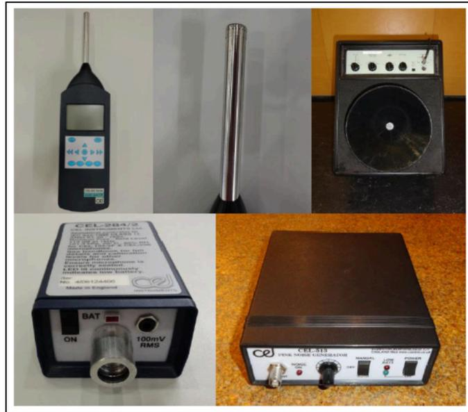
Figura 5. Equipamentos utilizados nas medições do T60
