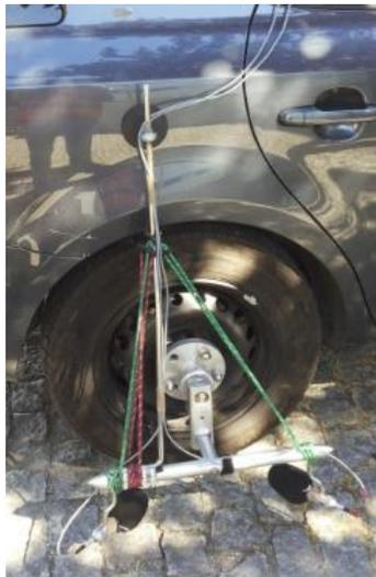
Figura 2. Método CPX montado no pneu de ensaio.
