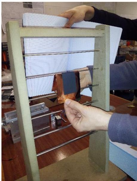
**Figura 8** – Fotografia de aparelho caseiro utilizado para a realização do *Bend Test*. O aparelho possui uma estrutura em madeira e seis barras metálicas, todas com diferentes diâmetros.
