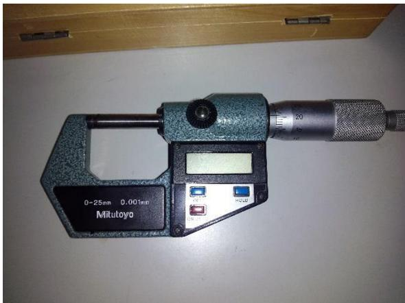
**Figura 7** – Imagem do Micrômetro digital da Mitutoyo utilizado. Intervalo de medições entre 0 e 25 mm com erro de  $\pm 0.001\text{mm}$
