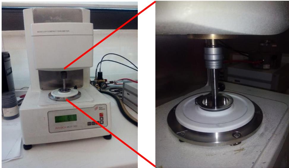
**Figura 11** – Fotografia do reómetro rotacional Physica MCR-300 (Anton Paar, Austria) utilizado nas medições reológicas.
