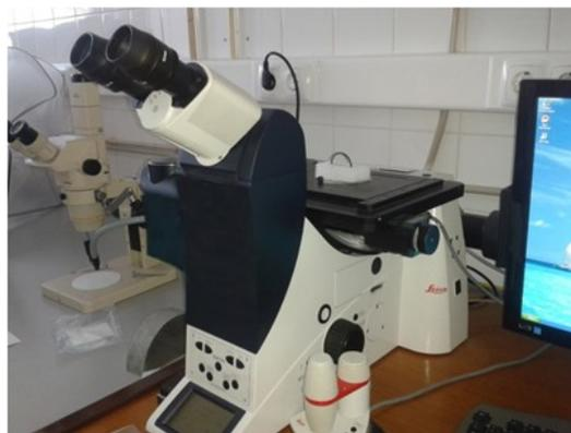
**Fig. 2.** Observação de uma argola por Microscopia Ótica no microscópio Leica DMI5000M instalado no CENIMAT/I3N da FCT-UNL.
