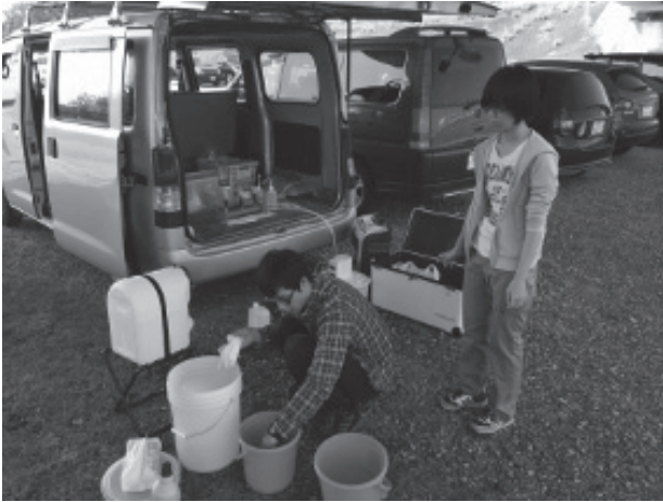
図3. 調査地での現場濾過の様子。調査車両には試料水運搬用のクーラー、発電機を含む濾過器材、洗浄用の水道水や超純水を含むブリーチ器材、フィルター試料を保存するための冷凍庫まですべてを積み込んで調査に向かう。
