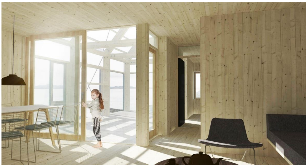
Illustrationen viser et kig fra køkken/alrummet ud i mellemzonen. Den viser også, hvordan vægge, gulve og lofter er beklædt med træ (krydslimede plader).
