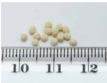
Pellets består af hovedsageligt af calciumkarbonat (kalk) og op til få procent metaller som jern og mangan samt podningsmaterialet som kerne. Deres diameter er 1-1,5 mm.
