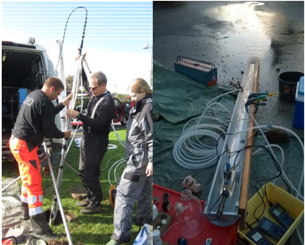
Figur 6: Niveauspecifik prøvetagning vha. separationspumpning med heat pulse probe til bestemmelse af vandskel. Nedsænkning af heat pulse proben (tv.) og opstilling til feltmålinger med flow celle (th.).
