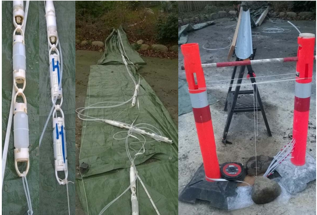
Figur 7: Niveauspecifik prøvetagning vha. passive snap samplere. Fra venstre: aktuator med to snap samplere til 125 ml flasker, line med række af sammenbundne snap samplere, og snap samplere installeret i boring.
