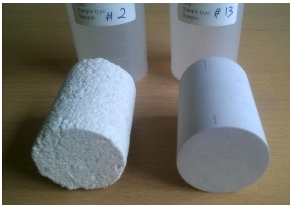
Figur 2.2: Illustration af kalkens beskaffenhed (hårdhed og struktur). Til venstre H2 kalk med kornet struktur og høj porøsitet og permeabilitet, til højre H4 kalk med glat struktur (cementeret) og lav porøsitet og permeabilitet.
