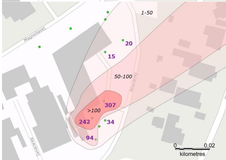
Figur 5.3. Horizontal udredelse af PCE ( \mu\text{g/L} ), maksimalkoncentrationer, på Akacievej 2 i forbindelse med pumpeforsøg i GEO17 når pumpe er tændt eller slukket. For pumpeboringen (GEO17) er alene vist koncentrationer fra før start af pumpeforsøget.
