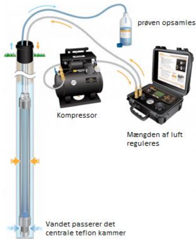
Figur 3.3. Prøvetagning ved hjælp af bladderpumpe. Vandflow er indikeret med blå pile, luftflow med gule pile. Illustration fra Solinst (2014) modificeret af Brabæk et al. (2015). Foto af udstyr og installation ses i Appendix A figur 8.
