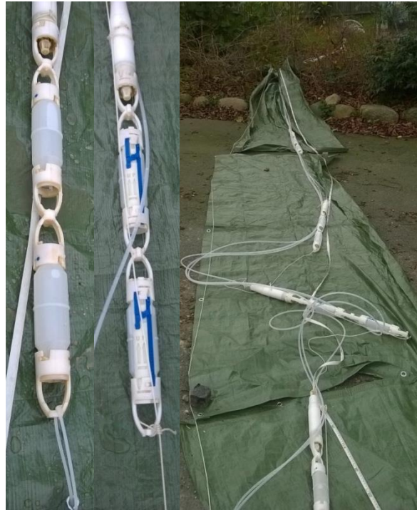
Figur 3.5. Aktuator med 2 snap samplere og kæde med snapsamplere klar til installation i boring. Bemærk vertikal placering af prøvebeholder som er åben i begge ender.
