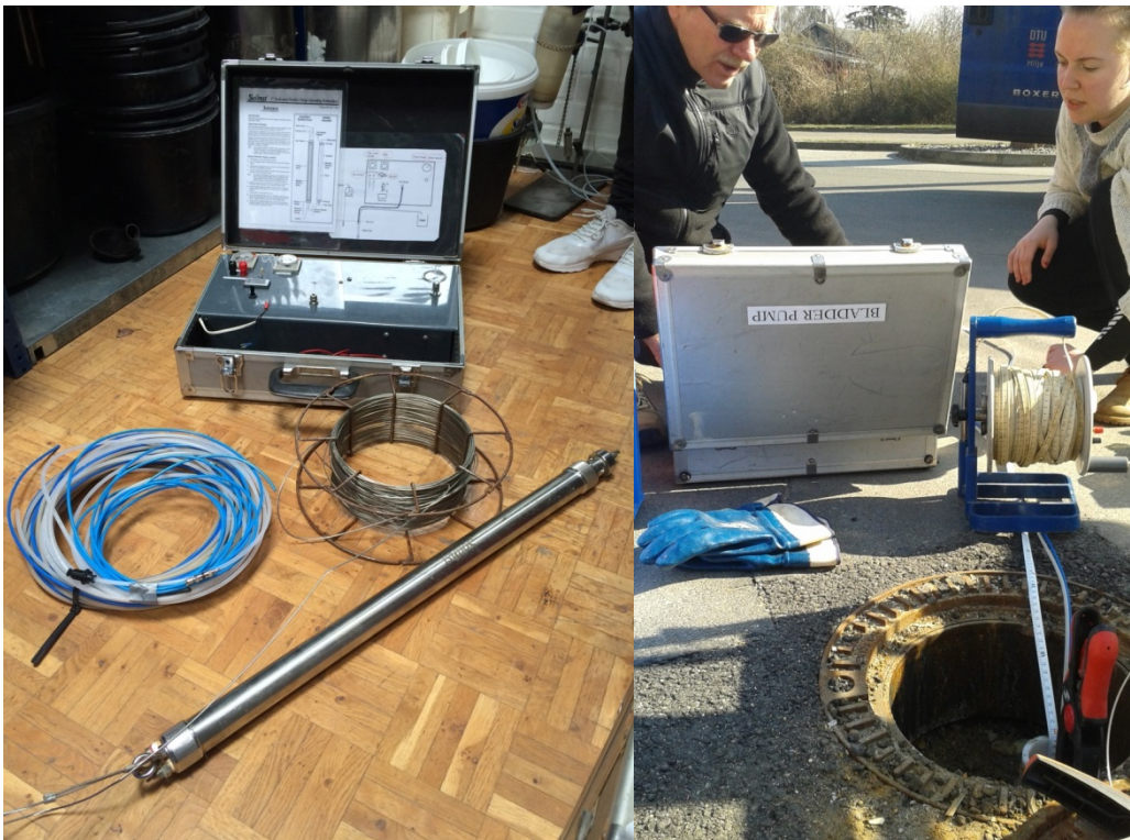
Figur 8: Niveauspecifik prøvetagning vha. lavt flow bladder pumpe. Venstre: bladder pumpe og kontrolenhed; højre: under anvendelse i felten.
