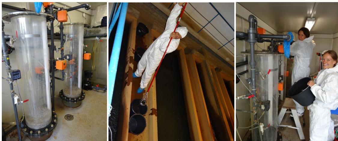
Figur 19. Filterkolonner med bærelag (venstre). Udtagning af sand fra sandfilter med grab sampler (midte). Tilsætning af sand i filterkolonner (højre). Foto: Sarah C.B. Christensen og Olaf W. Asmussen.
