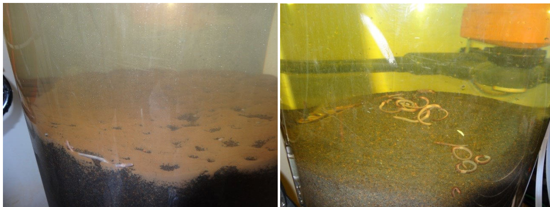
Figur 27. Død orm efter behandling med CO 2 (venstre). Der ses desuden et lag af fine partikler på overfladen af sandet som er blevet løsrevet ved gennemboblingen. Døde orme efter behandling med natriumhypochlorit (højre). Foto: Sarah C.B. Christensen.
