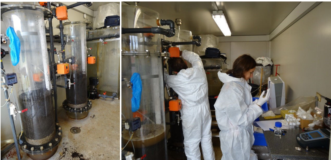
Figur 21. Færdigpakkefilterkolonner inden tilsætning af vand (venstre) og med lidt vand tilsat (højre). Foto: Sarah C.B. Christensen og Sille L. Larsen.
