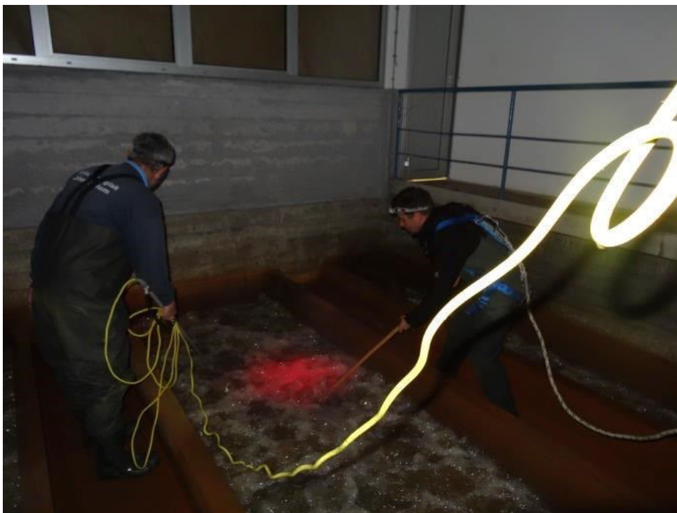
Figur 9. Prøvetagning med net under returskylning. På fotoet ses desuden udførelse af elektrofiskeri, men dette er ikke en del af metoden ”returskylning af filter”. Foto: Sarah C.B. Christensen.
