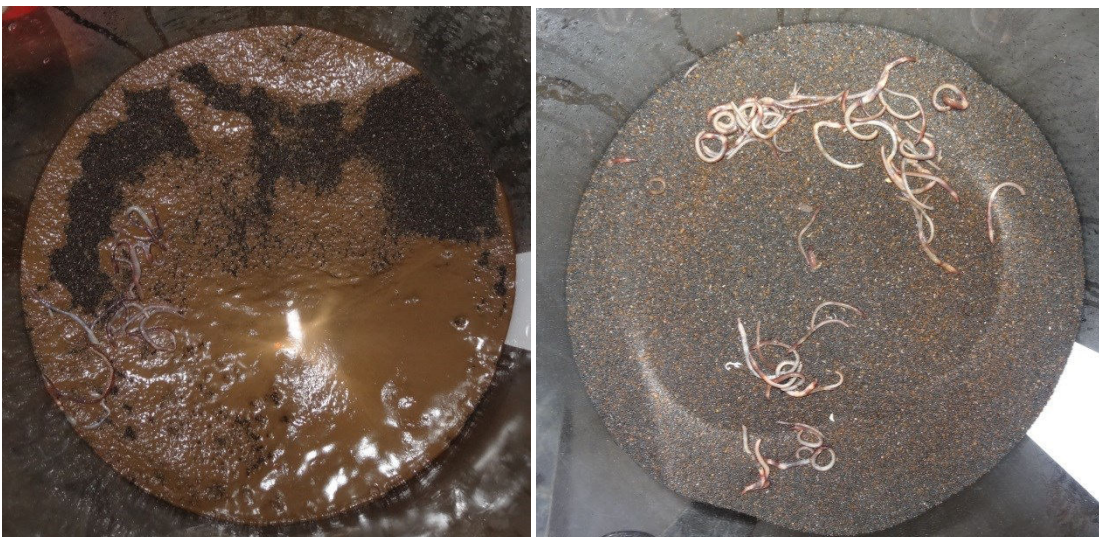
Figur 35. Overfladen af CO 2 behandlet filterkolonne (venstre) og kolonne behandlet med natriumhypochlorit (højre). CO 2 behandlede orme var opløste og bløde, mens de klorbehandlede orme havde en fast struktur. Ved gennembobling med CO 2 blev der frigivet finkornet materiale fra sandet, der lå på overfladen efter behandling. Foto: Sarah C.B. Christensen.
