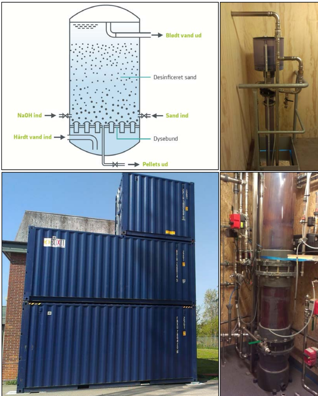
Figur 1 Skitse af pelletreaktoren opsat på vandværket og billeder af pelletreaktoren (Foto: Laure Lopato)
