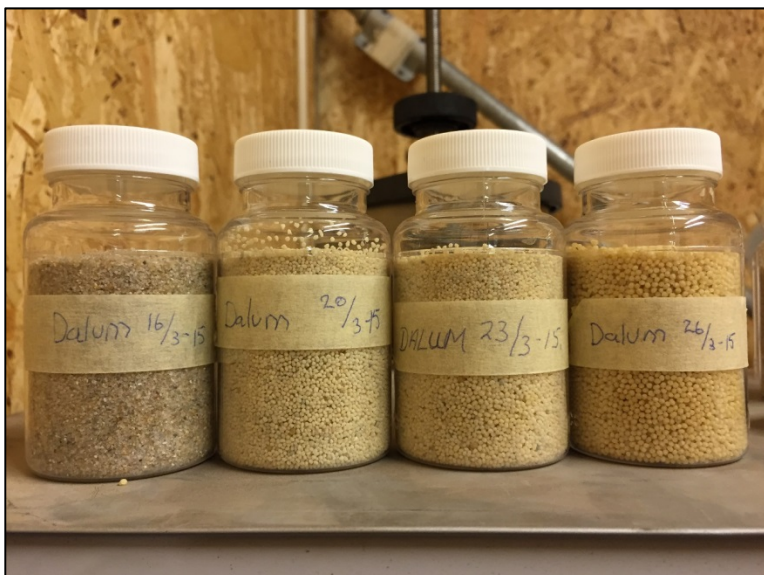
Figur 3 Rent sand fra d. 16. marts fra Dalumværket og pellets fra pelletreaktoren som de gradvist bliver større og større og til sidst tappes efter at have nået en størrelse på 1-1,5 mm.
