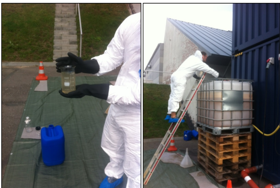
Figur 18 Forsøg med blødgøring som hygiejnisk barriere på Lindvedværket.
