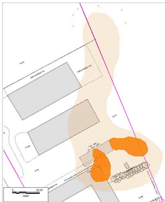
FIGUR 32: FORURENINGSUDBREDELSEN PÅ FLINTHOLMVEJ 6-8 AF PESTICIDER I MORÆNELERET OG DET NEDRE SANDLAG BASERET PÅ MÅLTE GRUNDVANDSKONCENTRATIONER (ORBICON, 2013).
