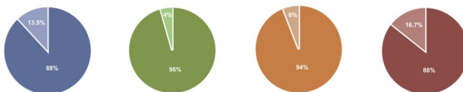
Figura 1: Contributo percentuale dell'analisi LCA all'interno delle quattro certificazioni ambientali multicriteri (in ordine di grafico: DGNB, LEED, BREEAM, Minergie-ECO)
