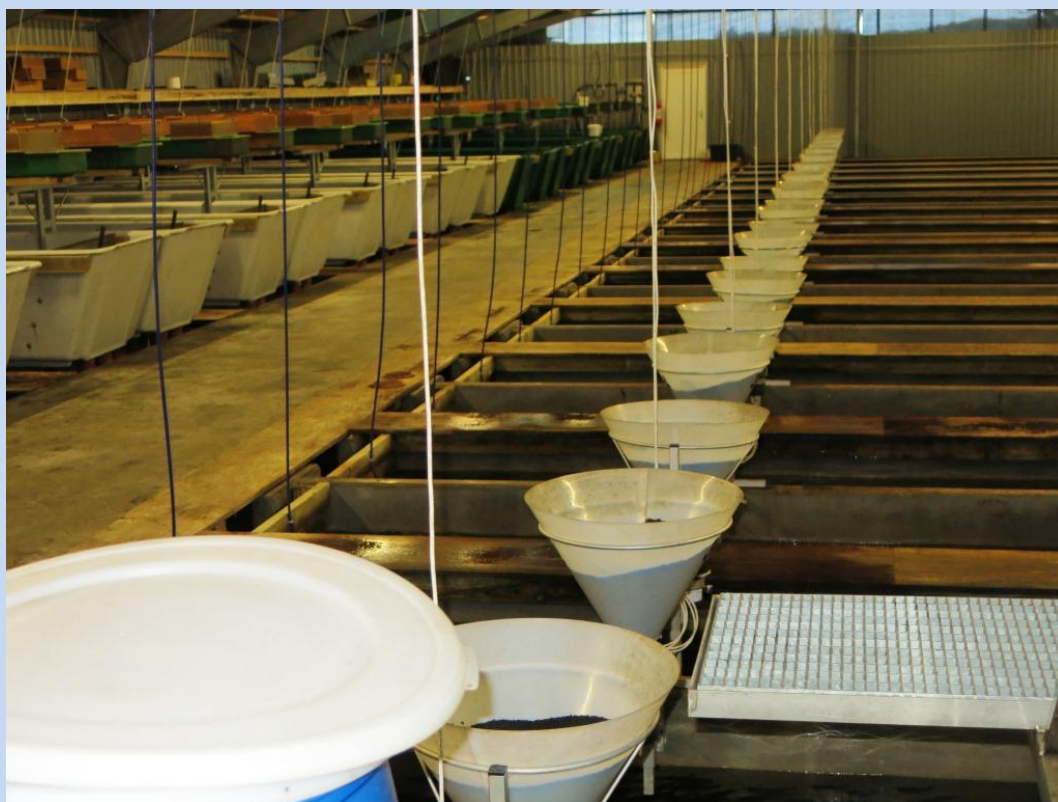
Figur 1. Hornbæk Dambrug med 30 klækkerender ( 0,15 \text{ m}^3 ), 30 glasfiber-tanke ( 2,4 \text{ m}^3 ) og 30 betonkummer ( 8 \text{ m}^3 ). Automatisk pereddikesyre-dosering foregår central ved anbringelse på indløbsrørene; rende og tanke forsynes med 60 \text{ l/s} friskvand, mens kummerne forsynes med 300 \text{ l/s} ; kombination af friskvand/recirkulering.
