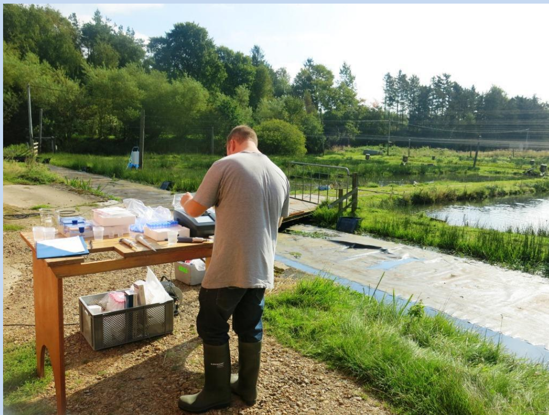
Målinger af pereddikesyre på stedet; i baggrunden ses doseringsanlæg og dam 44-46.
