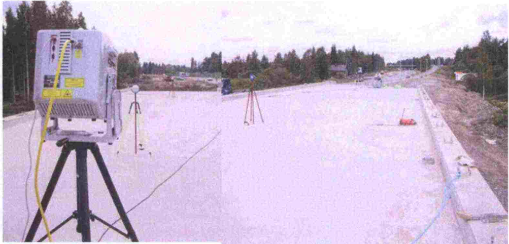
Kuvat 32-33. Silan kannen yläpinnan keilaukset.
