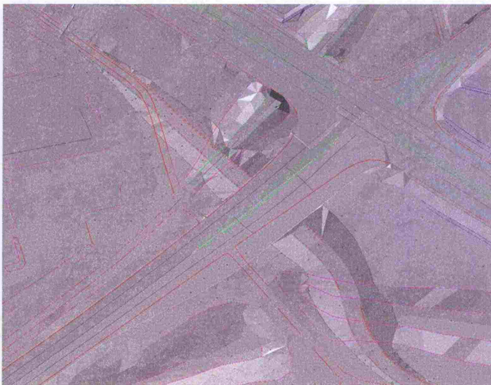
Kuva 44. Sillansuunnittelun lähtötiedoksi saatu digitaalinen maastomalli (Oulun pilottisilta).
