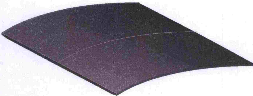
Kuva 20. Johtokäyrää pitkin pursotettu kansilaatta.
