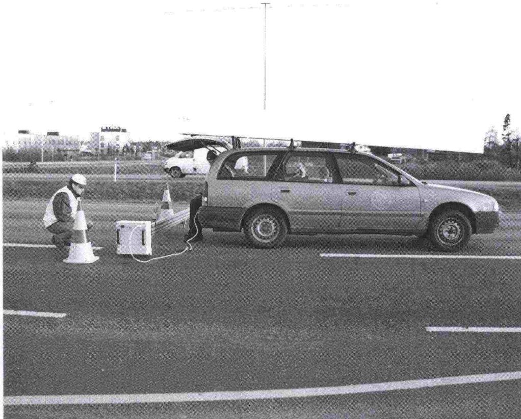
Kuva 9 Profiilien mittausta laserprofilometrillä
