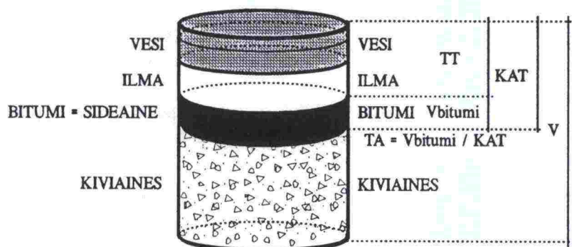
Kuva 2. Pehmeän päällysteen komponentit ja tilavuussuhteet /1/.
