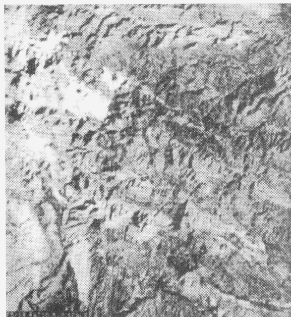
(d) TM ratio 5/7 after low pass filtering
