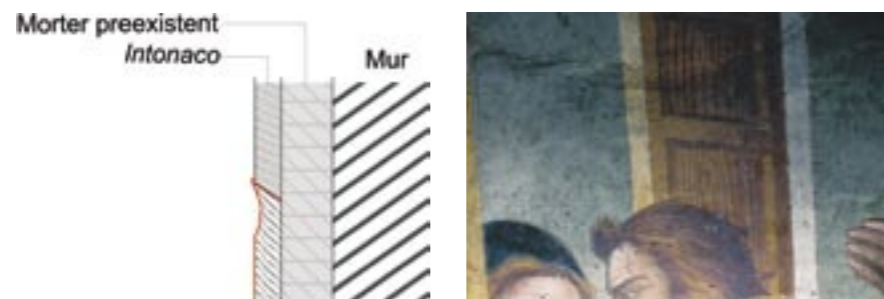
Junta de morter amb el lliscat de la giornata posterior per sota del nivell desitjat.
