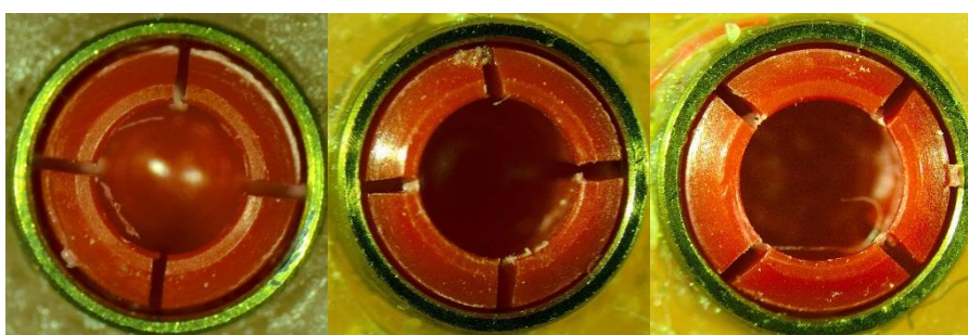
Figura 56 – Clix ® Rojo en el inicio, final del estudio a 0° y 20°
