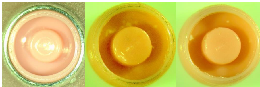
Figura 61 – Locator ® rosa en el inicio, final del estudio a 0° y 20°
