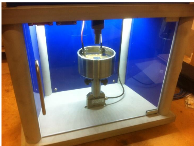
Figura 35 – Resguardo móvil con enclavamiento
