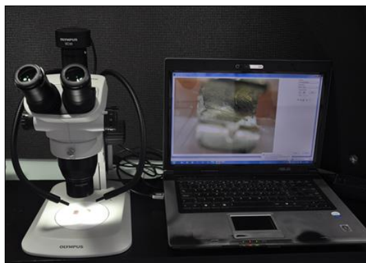
Figura 44 – Microscopio estereoscópico con cámara fotográfica y ordenador
