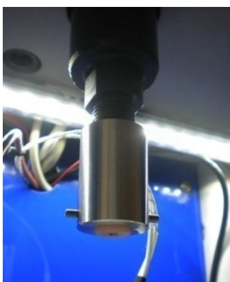
Figura 25 – Utillaje de unión superior roscado al actuador
