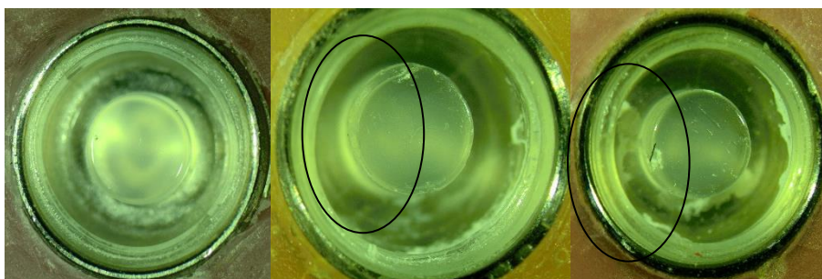
Figura 59 – Locator ® blanco en el inicio, final del estudio a 0° y 20°
