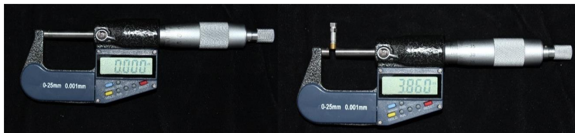
Figura 45 – Micrómetro digital y medición de un pilar Locator
